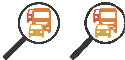
Abbildung 3.22: Max Pooling (2048x2048x3 → 64x64x3)
