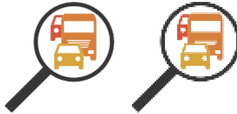
Abbildung 3.20: Max Pooling (128x128x3 → 64x64x3)
